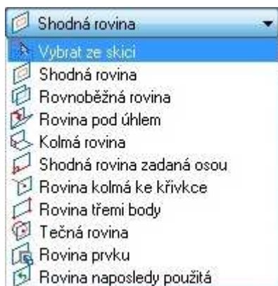
Obr. 2 – Rozbalené menu pro výběr ze skici či definování roviny pro vytvoření skici nové
